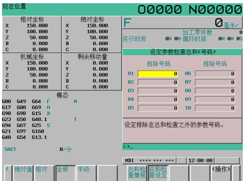
图 13.1.6 (f) 参数总和和检查设定画面(10.4 英寸)
