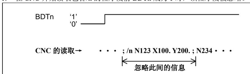
2. 在 CNC 在读取包含/n 的程序段中 BDTn 成为‘1’时，该程序段不会被忽略。
