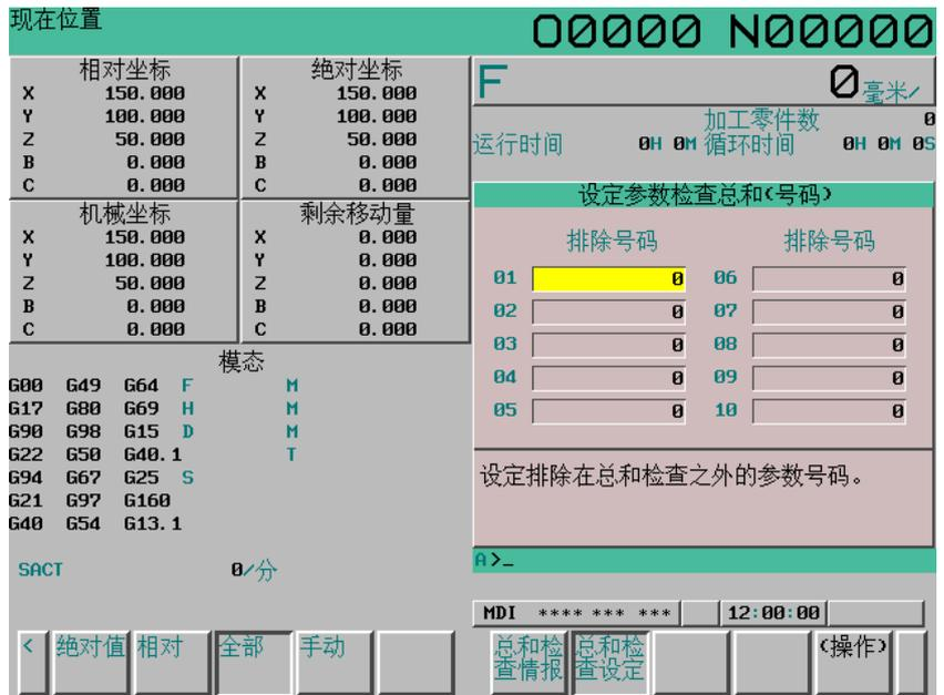
图 13.1.6 (b) 设定参数总和检查(号码)画面
