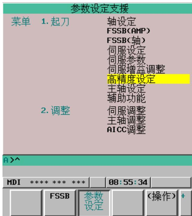
移动光标到“高精度设定”，然后按“操作”，选择“初始化”[INIT]，即可进行高精度参数
