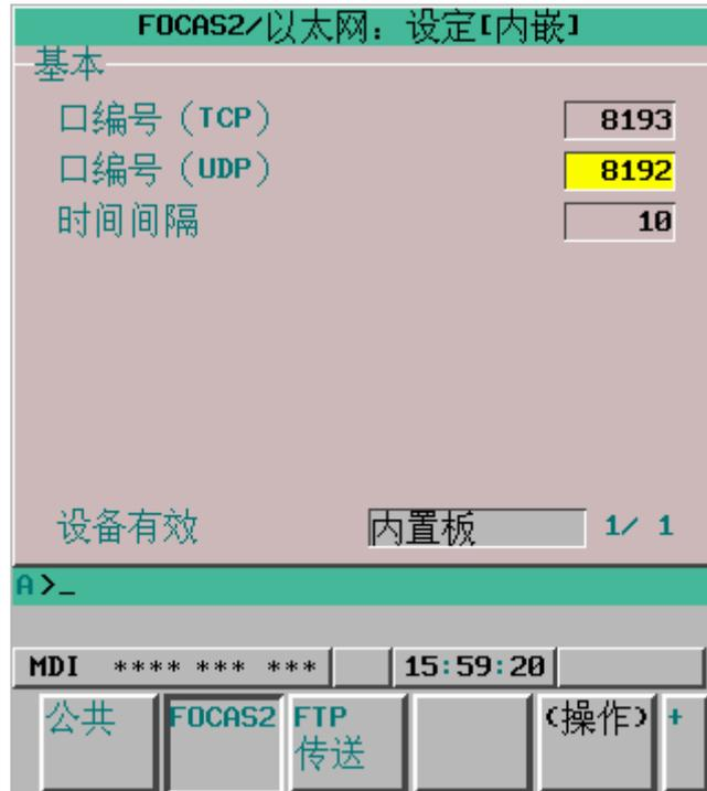
设定 TCP 和 UDP 端口，以及时间间隔，通常 TCP 端口为 8193，UDP 端口为 8192，时间间隔根据实际需要设定，一般来说设定 10 秒钟即可。
