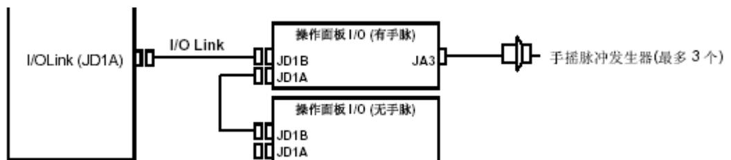
注意：对于手脉接口，0iC 在控制器的 I/O 单元上或操作面板 I/O 上都有，可以根据需要连接到哪个接口，在 PMC 的模块地址分配时要指定。
