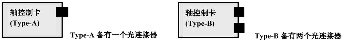
在使用伺服 HRV3 控制时，可以连接到每个光连接器上的放大器轴数为 4 轴，分离式检测器接口单元数为最多可以连接一个单元。伺服放大器轴数大于等于 5 轴或者使用备有两个分离式检测器接口单元时，需要 Type B 卡。
