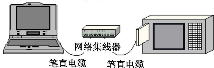
通常，在利用 HSSB 时，您可能会用光缆将 CNC 和个人电脑连接起来。使用 SERVO GUIDE 并不需要除此之外的特殊的连接。
