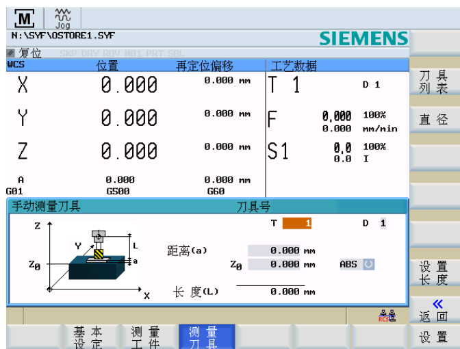
图 4-10 “手动测量刀具”窗口，测量长度
