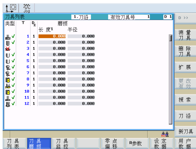
图 4-2 标准刀具磨损
