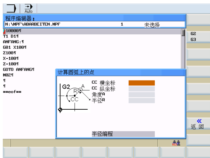
图 7-11 计算：圆弧上的点
