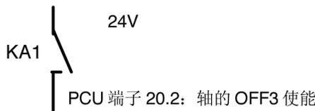
在图上的方案中，任意硬限位或者急停出现时，可以由硬件逻辑激活对所有轴的进给停止（例如，通过继电器断开PCU的端子X20.2的24V）。利用上表所示的硬限位编码可以作为PLC诊断时的信息，判断急停信号是由急停键产生或是其轴某方向的硬限位造成。
